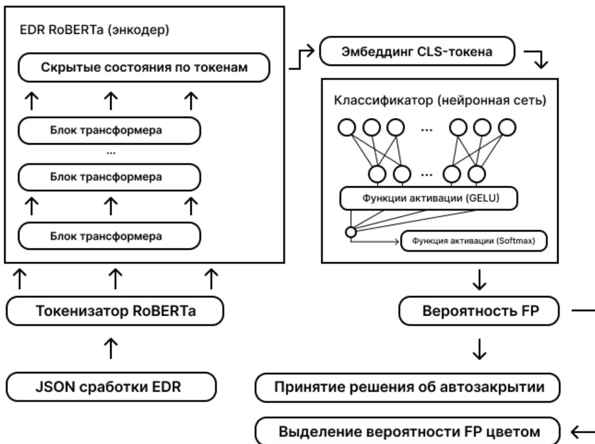
**Рисунок 107 – Схема применения модели классификации инцидентов**
