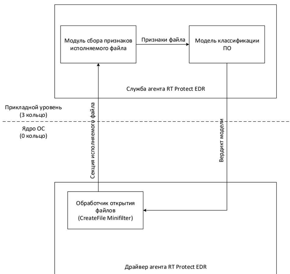
Рисунок 108 – Схема применения модели классификации ПО
