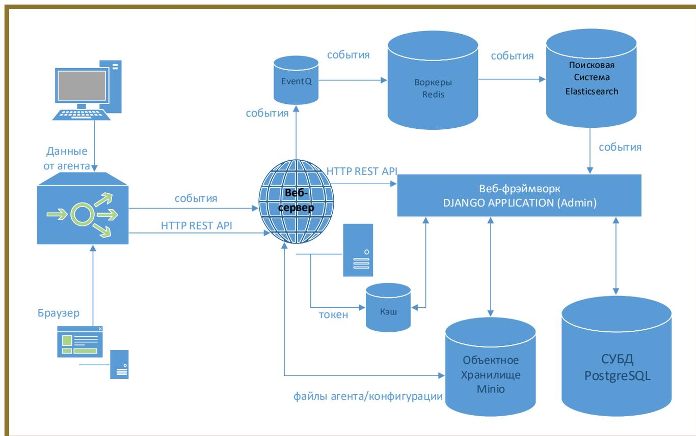
Рисунок 3 – Архитектура серверной части «RT Protect EDR»
